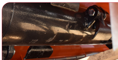
Martillos sobre eje de 168 mm.
