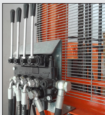
Control hidráulico de la ES70580
